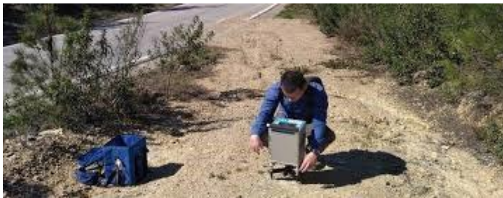
Abbildung 1 Techniker bei der Durchführung einer gravimetrischen Messung mittel Gravimeter (CG-5)
